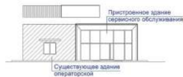
Вариант внешнего вида операторской в случае пристройки павильона к существующей операторской АЗС.
