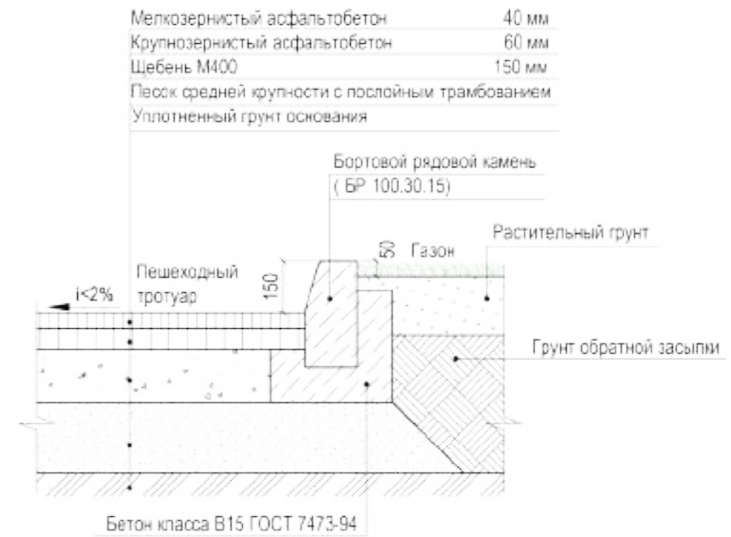
3.13.1 Схема устройства сопряжения асфальтобетонного покрытия и газона
